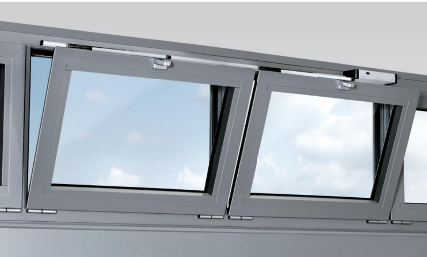
Das Oberlichtöffnersystem, bestehend aus dem Oberlichtöffner VENTUS und dem Elektroantrieb ELTRAL, ermöglicht eine kostengünstige elektromotorische Ansteuerung von mehreren Flügleinheiten. Durch die flache Bauweise der Öffnerscheren lässt sich das System zur Entrauchung und täglichen Lüftung an einwärts öffnenden, vertikal eingebauten, rechteckigen Kippfenstern aus
