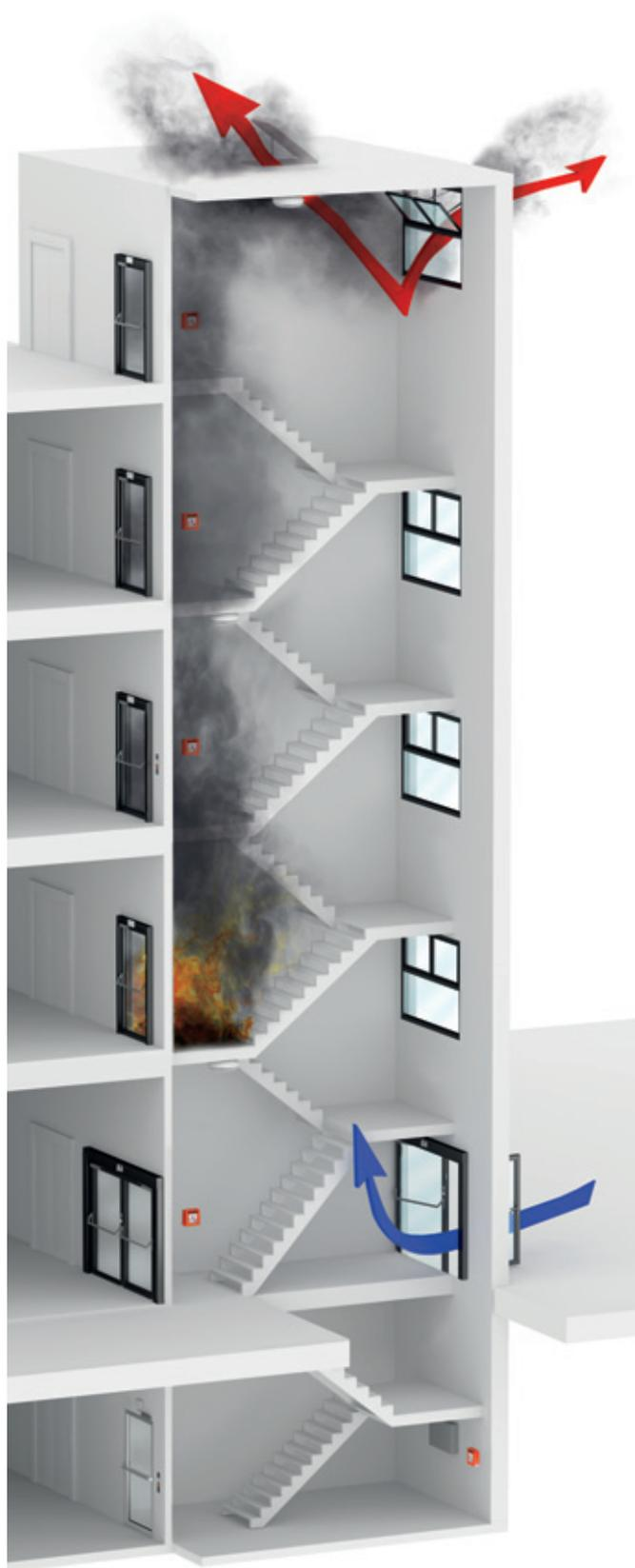
RWA-Anlagen bestehen im Wesentlichen aus den Systemkomponenten, wie sie im nebenstehenden Systemaufbau ersichtlich sind. Sie decken zwei große Aufgabenkreise ab: den Alarmfall und den täglichen Lüftungsfall.
