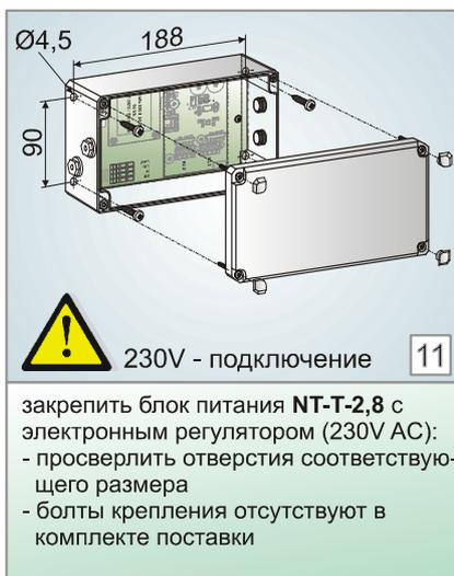
закрепить блок питания NT-T-2,8 с электронным регулятором (230V AC):
