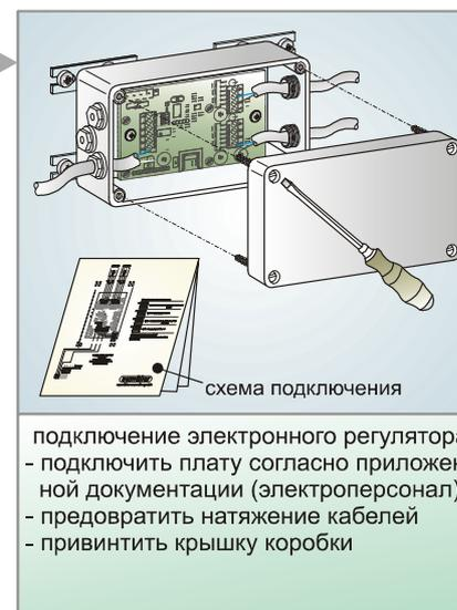
подключение электронного регулятора:
