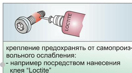
крепление предохранять от самопроизвольного ослабления:
