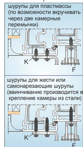
Использование подходящих шурупов зависит от материала окна, а также подготовке и толщине стенки профиля. Далее от ожидаемых сил, передаваемых от привода на окно. В зависимости от системы профиля могут использоваться различные средства крепления. Это необходимо проверить до начала производства монтажных работ.
