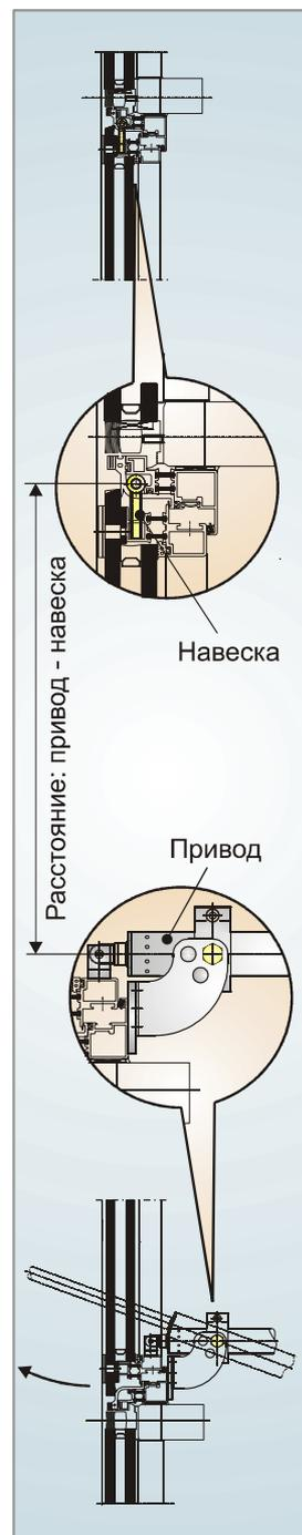
**Указание:** При монтаже приводов на ОсП решающее значение для угла открывания имеет высота створки, при боковом монтаже на ПоП решающее значение имеет расстояние до навески!
