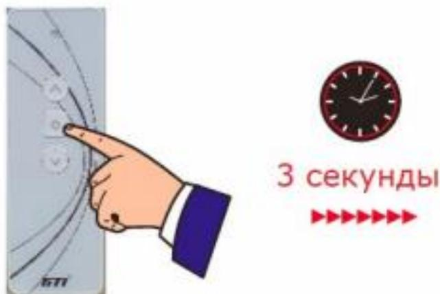
На блоке управления загорится светодиод на 1 секунду в подтверждение получения команды - пульт успешно подключен к блоку управления.
