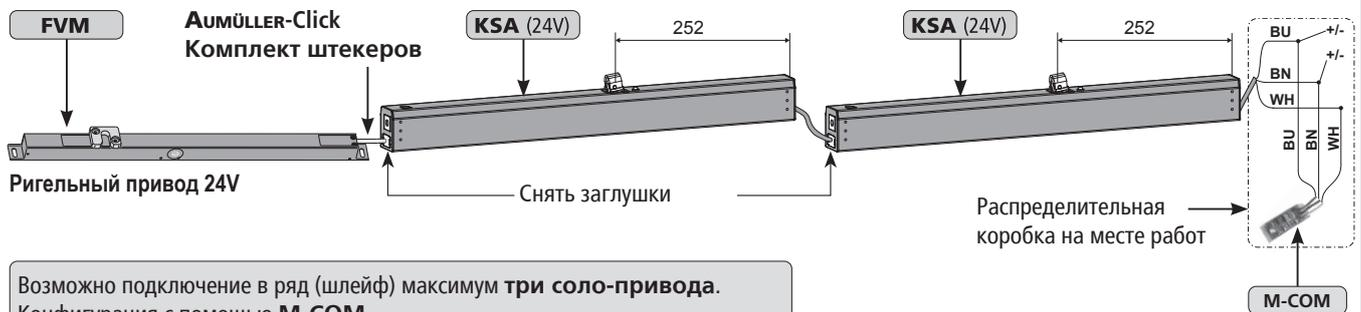
Возможно подключение в ряд (шлейф) максимум три соло-привода. Конфигурация с помощью M-COM.
